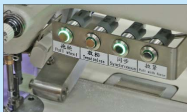
O-D-10-01 三段速度控制系統 3-stage speed control system
